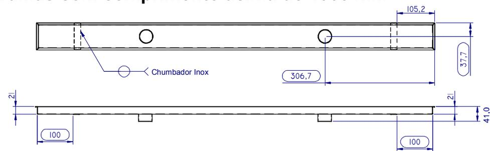
\*as calhas acima de 1000 mm apresentam duas saídas para garantir a capacidade de vazão.
