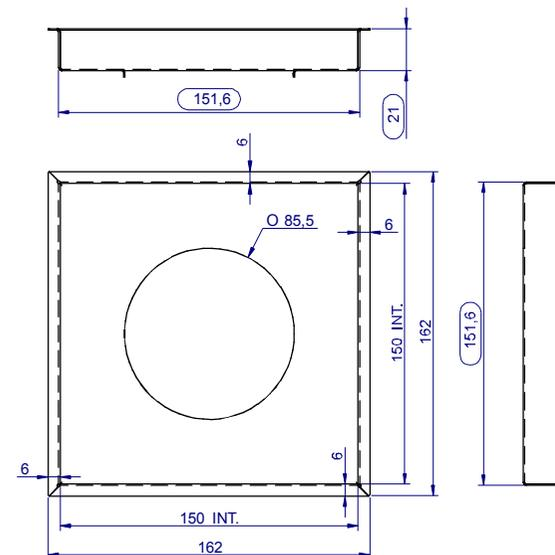
3 - Recorte do próprio piso ou do revestimento de sua preferência um quadrado com cerca de 143 x 143 mm e cole-o sobre a tampa de inox usando selante de poliuretano. Mantenha um espaço mínimo de 3 mm entre a tampa e o piso.
